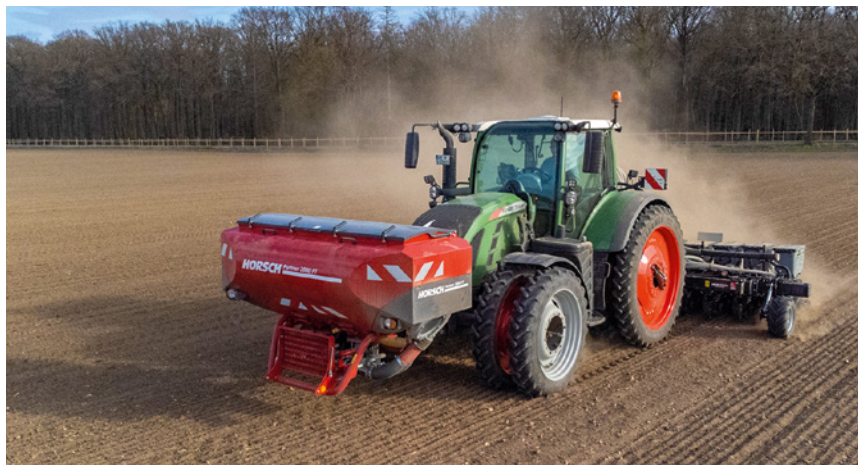
Die Precision Planting legt das Saatkorn und den Dünger bei wechselnden Bodenverhältnissen präzise ab.
